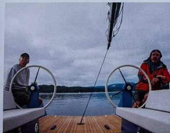
MÅTTE ENDRES: De to sorte klossene på dekket fungerer som støtte for kapteinen når båten heller. De måtte byttes ut fra det opprinnelige designet i treverk, som gikk i ett med dekket og skapte snublehinder.
